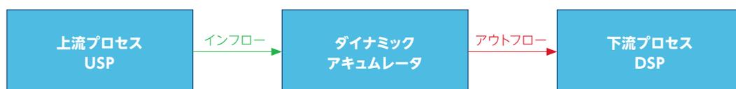
ダイナミックアキュムレータによる上流、下流プロセスの調整
